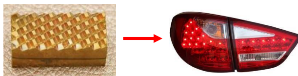
Ex. 全反射車燈殼模具 TiN 鍍膜應用
