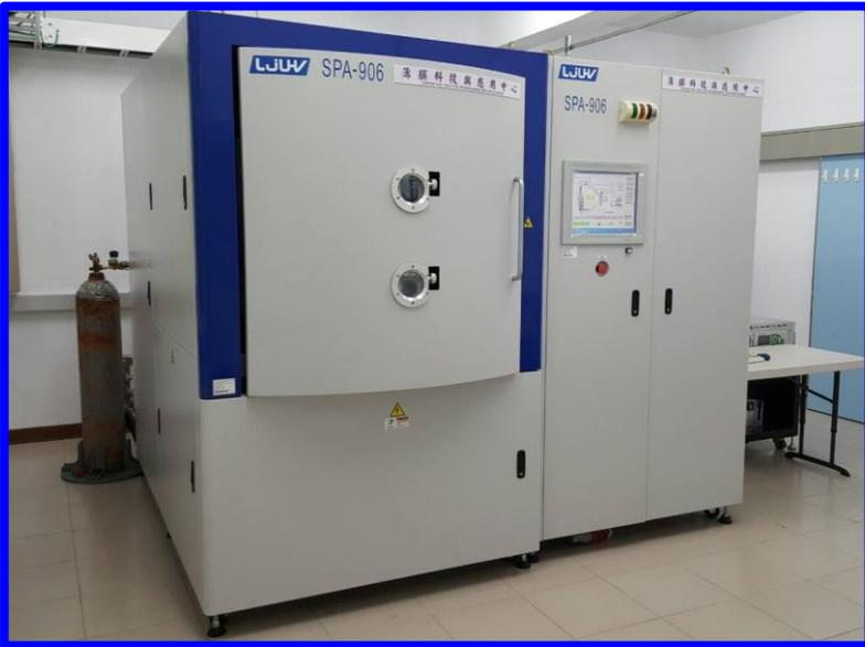
本中心設計製造的HiPIMS + Arc複合式鍍膜設備(NT\$1800萬元)
